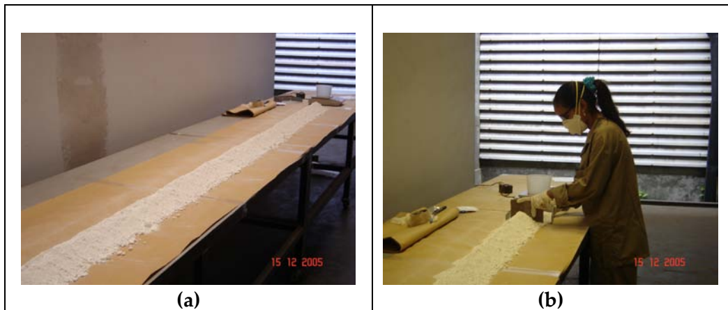
Figura 3 – Pilha de homogeneização. Em (a), vista geral do material na pilha e, em (b), tomadas de alíquotas para ensaios em laboratório.
