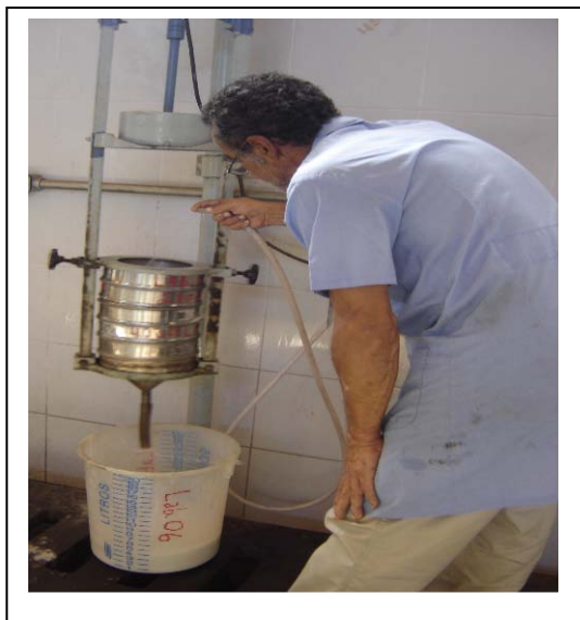
Figura 5 – Peneiramento a úmido, em escala de laboratório.
