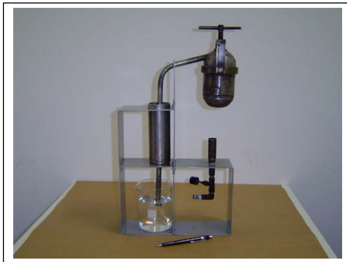
Figura 1 – Retorta do CETEM (RETORCET) utilizada para retortagem de amálgama de ouro e mercúrio.
