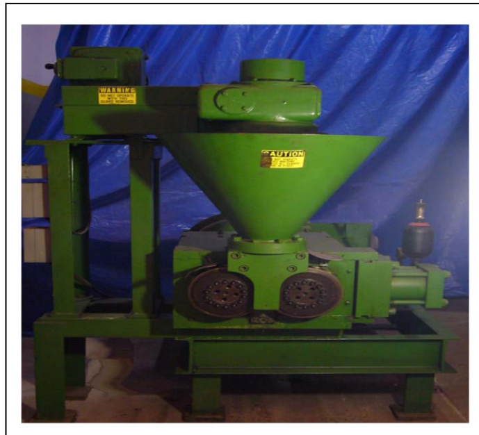
Figura 1 – Máquina contínua de briquetagem existente no CETEM.
