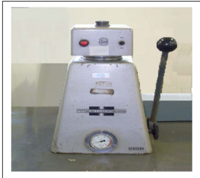
Figura 3 – Prensa de pistão, existente no CETEM, utilizada para ensaios descontínuos em laboratório.
