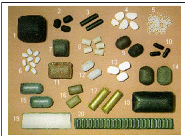
Figura 2 – Formatos de briquetes obtidos por meio de prensas de rolos.
