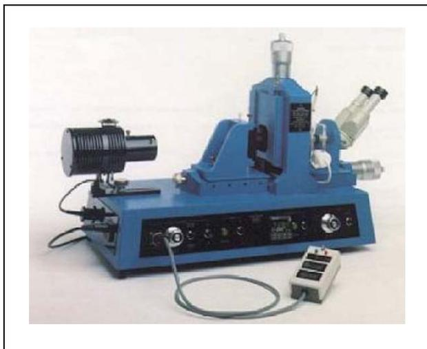
Figura 4 – Aparato de microeletroforese Mk II da Rank Brothers, na montagem para célula plana.
