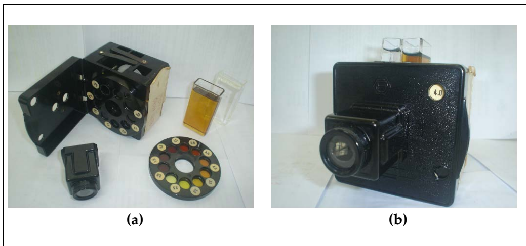
Figura 3 – Colorímetro ASTM. Em (a), seus acessórios e, em (b), colorímetro preparado para a medida de cor.
