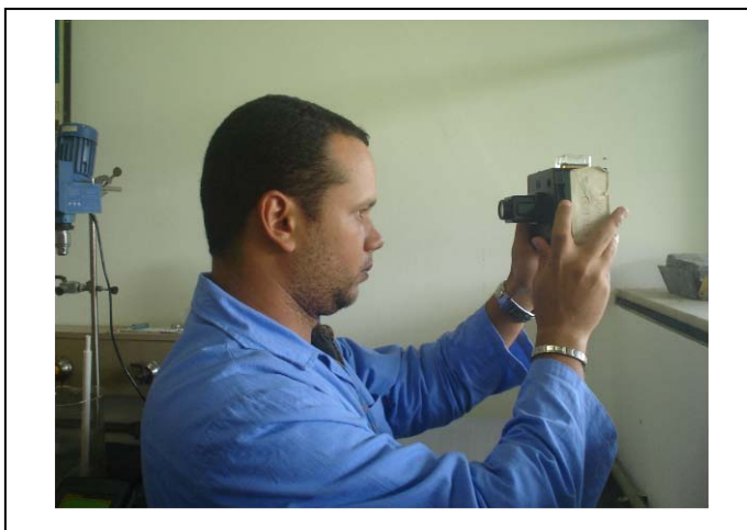
Figura 4 – Posicionamento do colorímetro ASTM, existente no CETEM, para determinação de cor.
