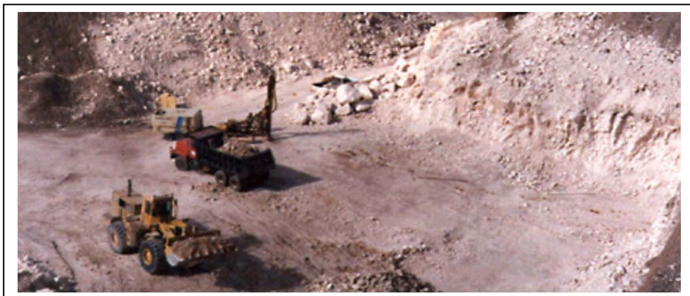
Figura 6 – Mina a céu aberto do minério zeolítico da mineração Sant Cloud nos EUA.
