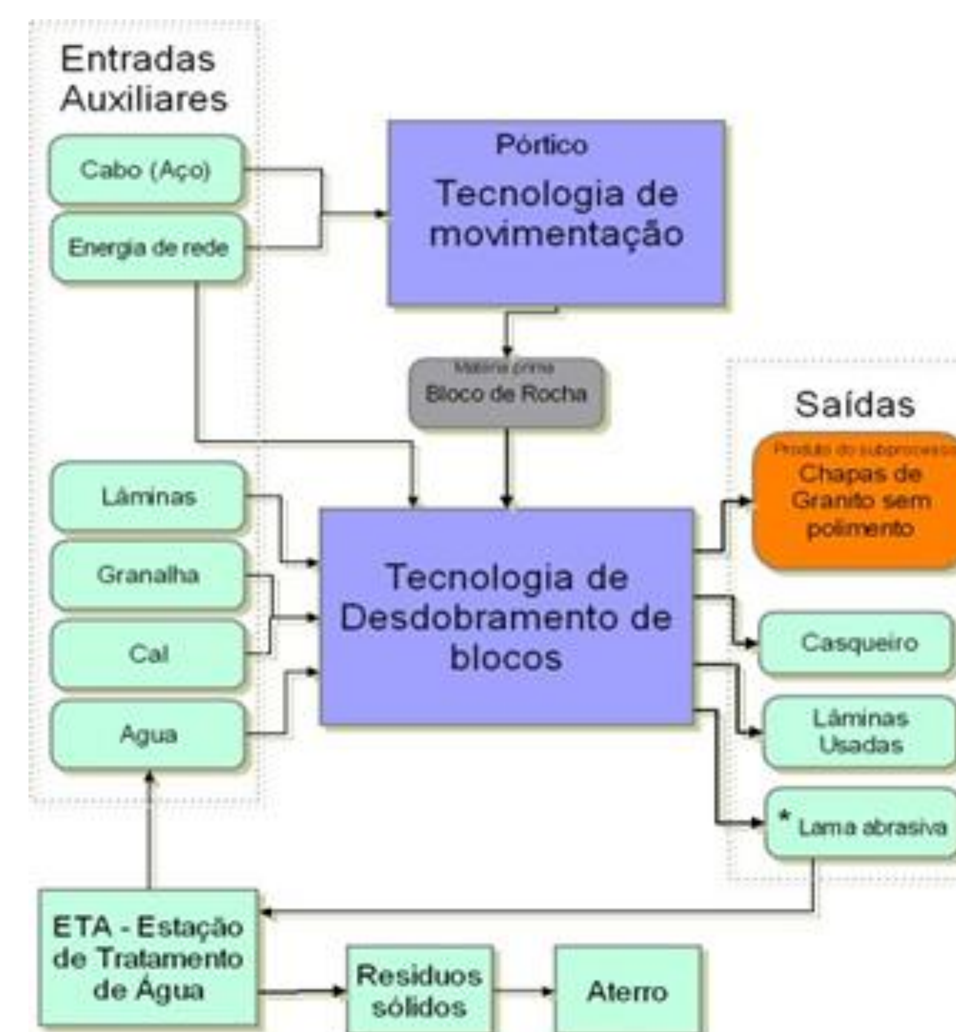
Figura 2: Fluxograma das Entradas/Saídas do Processo de Serragem de Rochas Ornamentais
