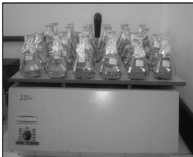
Figura 2. Experimento de extração de potássio: contato entre a solução extratora e a amostra mineral
