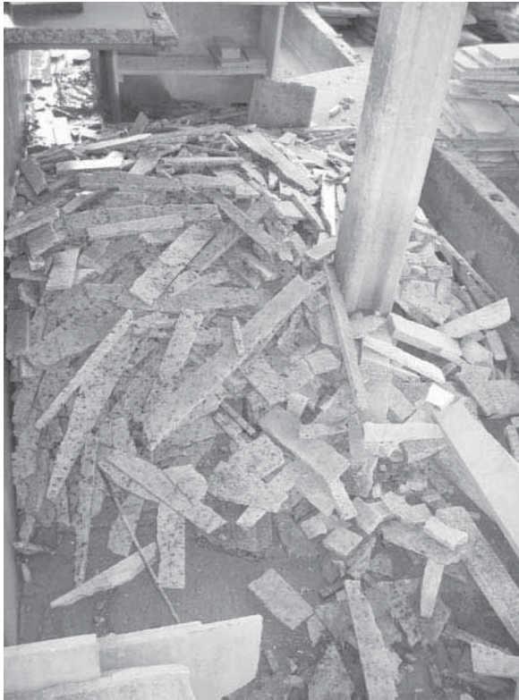
Foto 10 – Tiras quebradas do esquadrejamento f. autor).
