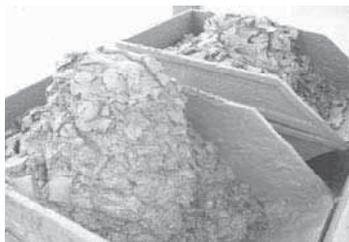
**Figura 1:** Lama Abrasiva (Serragem)
