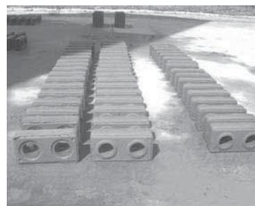
**Figura 12:** Tijolo de solo-cimento com lama abrasiva
