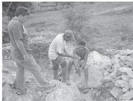
**Figuras 2 e 3:** Extração e calcinação do calcário metamórfico
