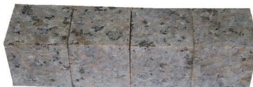
**FOTO 3 – Vista geral dos cubos do granito Meruoca Clássico. Na face superior temos uma visão do que estamos chamando de maior concentração de minerais máficos, na face inferior observa-se as menores concentrações. Notar a grande dificuldade da separação entre elas.**
