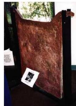
Figura 2. Tamanho original de um ânodo de cobre *blister*.
