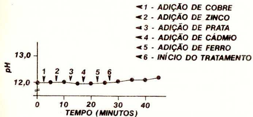
FIG.10 - COMPORTAMENTO DO pH FRENTE AO PROCESSO DE CLORAÇÃO ALCALINA.
