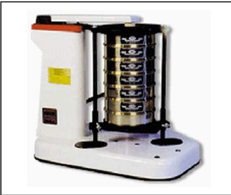
**Figura 14.** Peneiramento a seco – Rotap.
