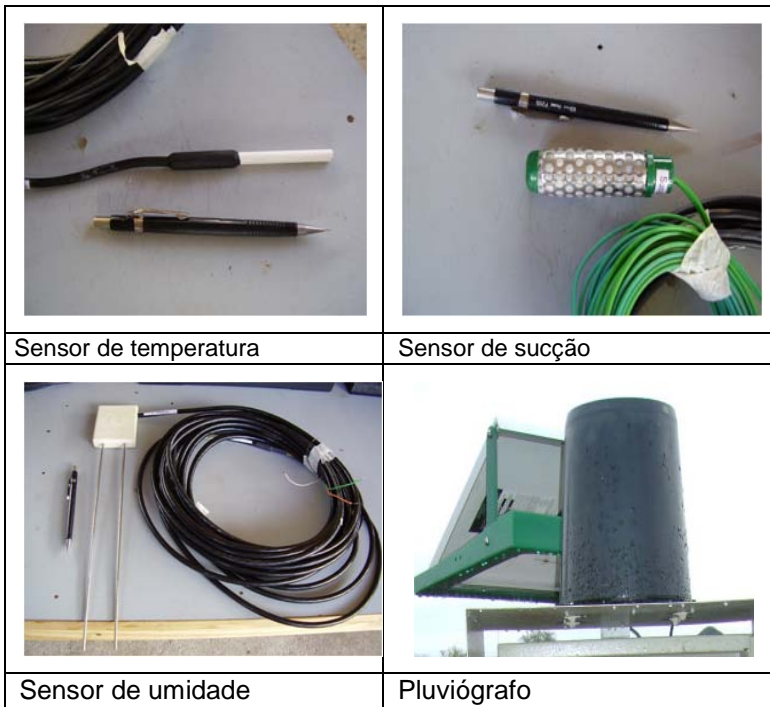
Figura 9. Sensores e pluviógrafo instalados na EEJPB.
