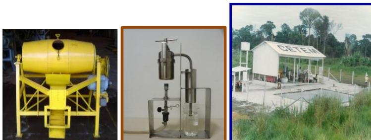
**Figura 1:** Fotos do tambor amalgamador, da RETORCET e da unidade experimental (UE), implantada em Píririma (BRAGA, 2014).
