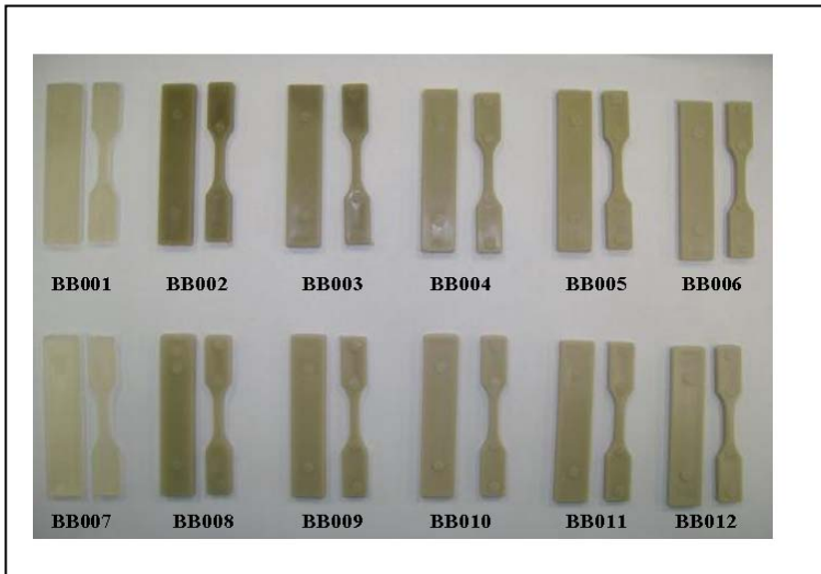
Figura 26. Corpos de prova ordenados segundo sua composição (%) de resíduo.
