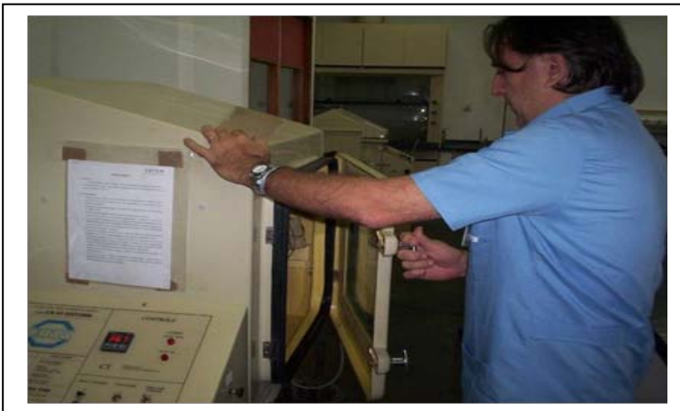
Figura 25. Exposição dos corpos de prova à ação de \text{SO}_2 .
