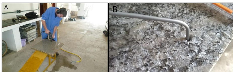
Figura 2: Procedimento de furação e instalação do termopar.
