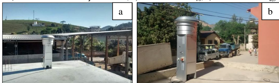
Figura 2: Amostradores de Grande Volume – AGV/“HiVol” instalados no Distrito de Itaoca Pedra, Cachoeiro de Itapemirim-ES. a) Ponto/local de medição de PM 10 , b) Ponto/local PM 2,5
