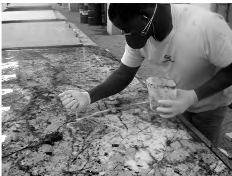
**Figura 42** - Estucamento numa chapa com fissuras abertas. Foto: CETEM/MCTI, 2009.
