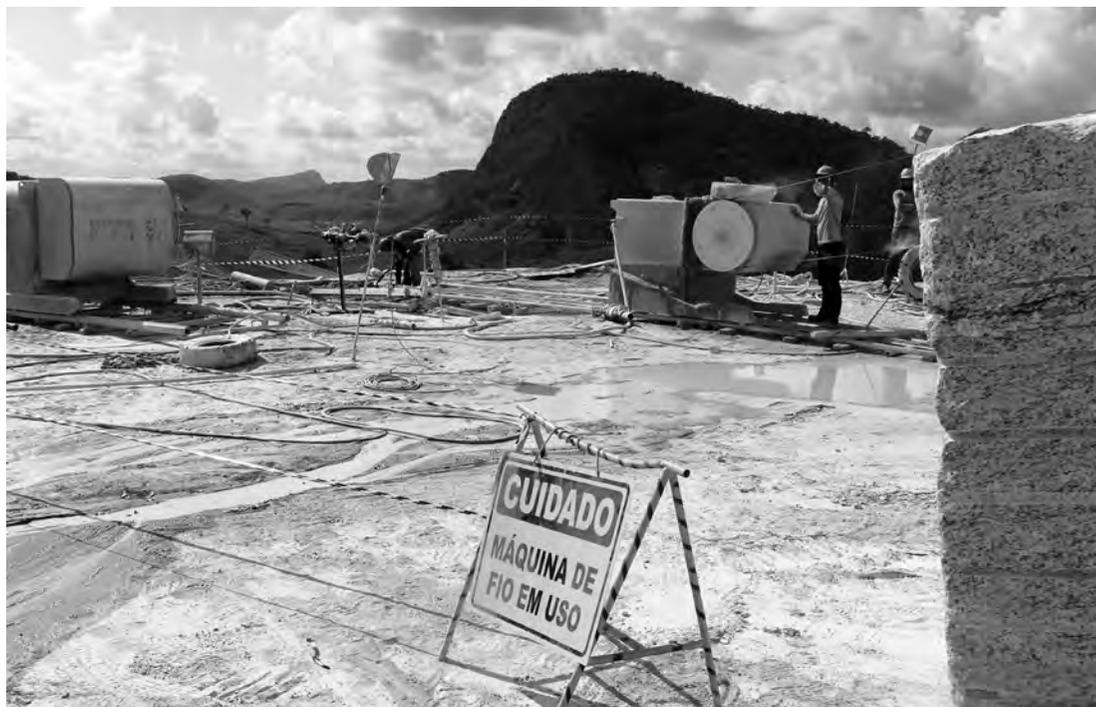
**Figura 6** - Operador de Máquina de fio diamantado em pedreira. Foto: CETEM/MCTI, 2012.
