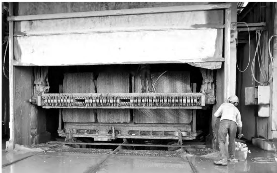
**Figura 8** - Operadores de tear multilâmina retirando as chapas. Fonte: CETEM/MCTI, 2011.
