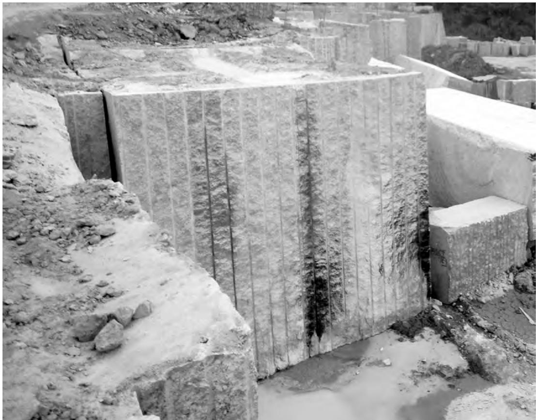
**Figura 21** - Quadrote isolado na bancada. Foto: CETEM/MCTI, 2013.
