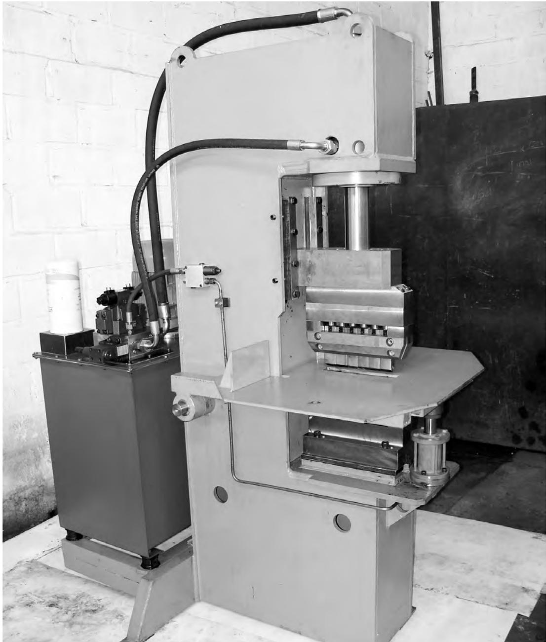
**Figura 33** - Prensa “quebra-pedras”, da marca Volpi. Foto: Volpi, 2013.
