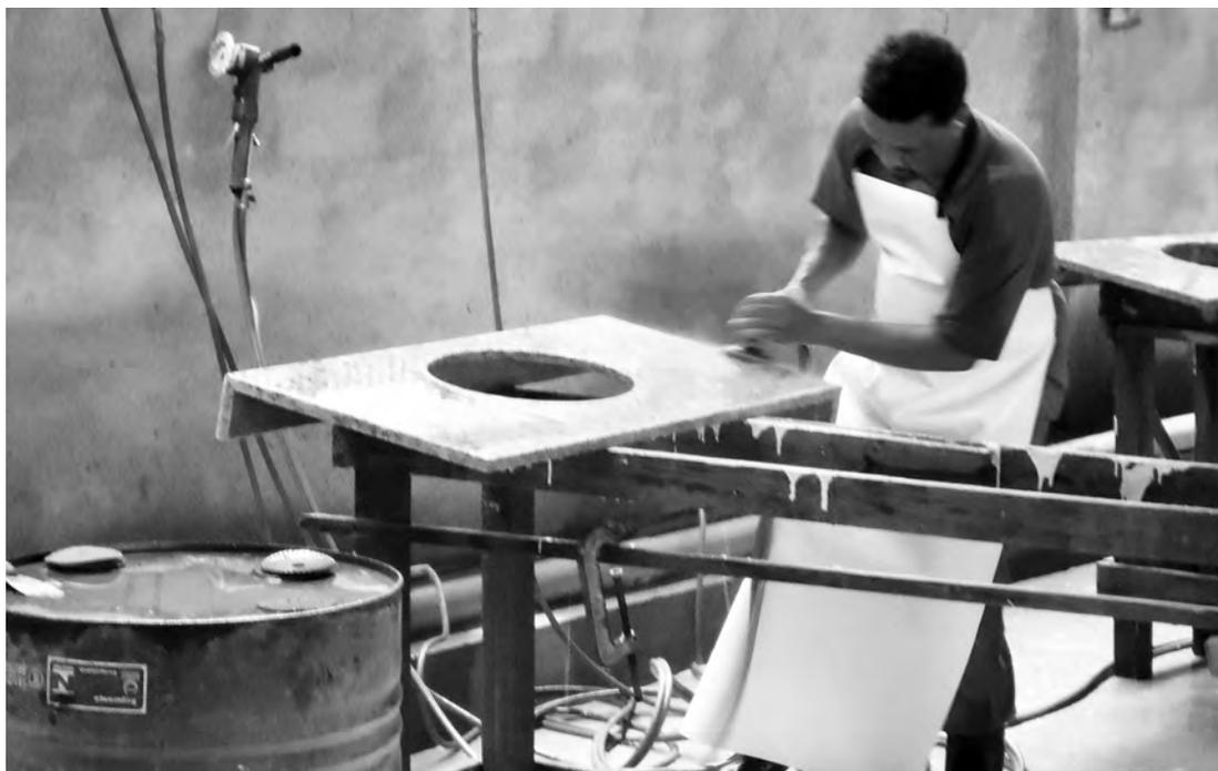
**Figura 90** - Retoque no acabamento de borda com lixadeira manual. Foto: CETEM/MCTI, 2010.
