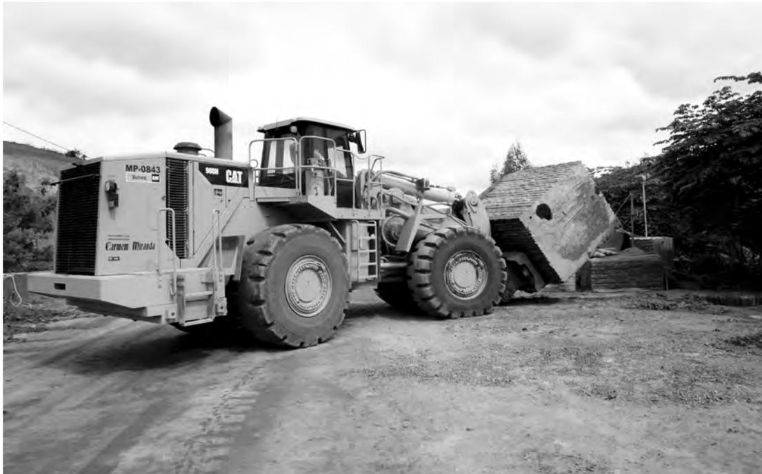
**Figura 87** - Pá carregadeira usada na movimentação de blocos. Foto: CETEM/MCTI, 2012.
