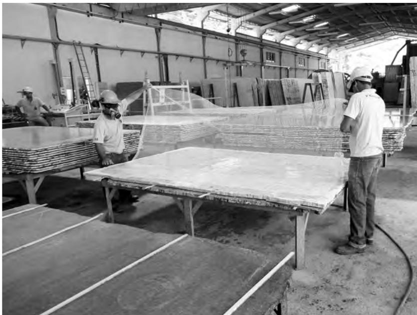
**Figura 12** - Operadores de resinagem colocando a tela. Foto: CETEM/MCTI, 2012.
