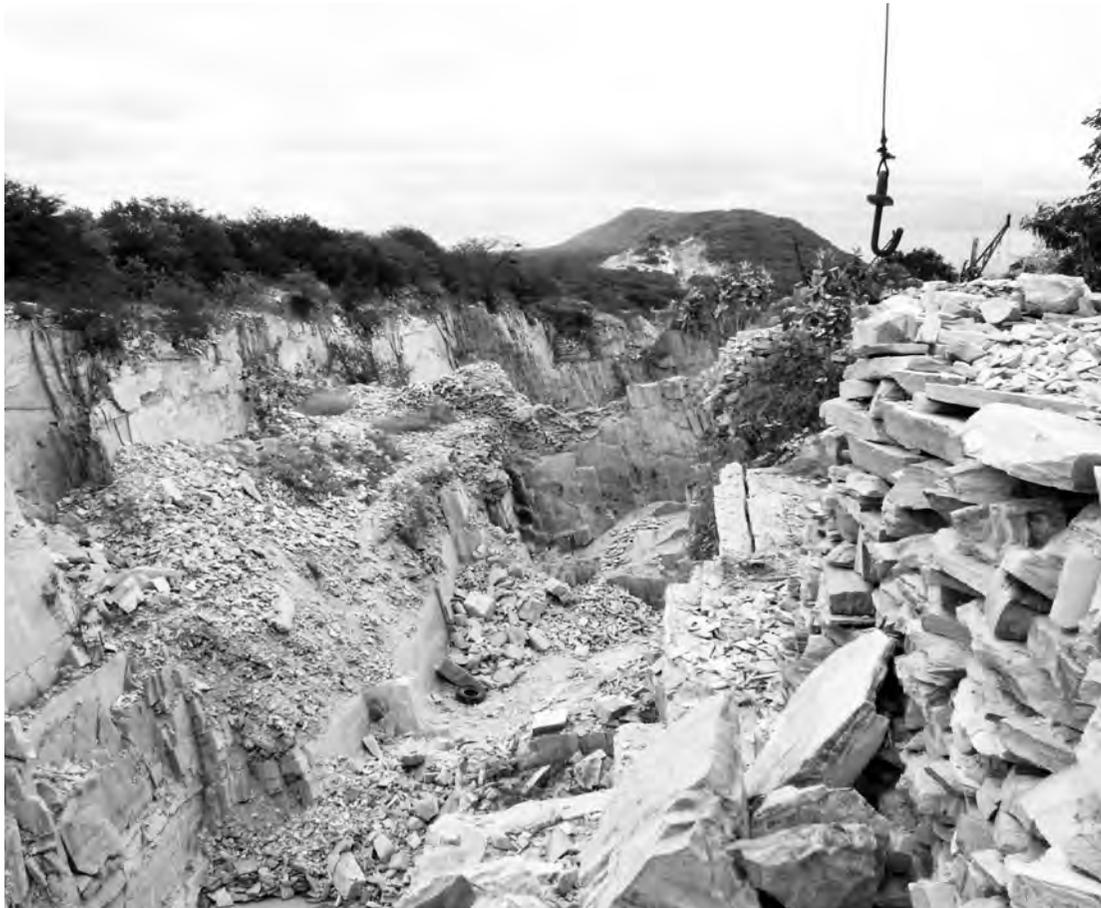
**Figura 2** - Riscos pelos taludes instáveis e resíduos mal dispostos. Foto: CETEM/MCTI, 2011.
