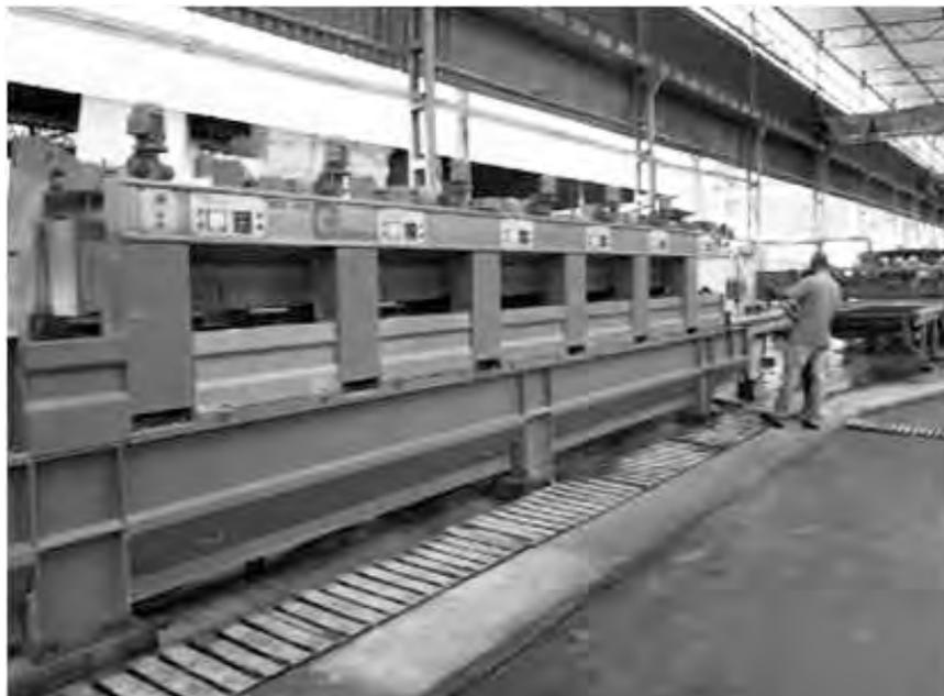
**Figura 73** - Máquina calibradora de ladrilhos. Foto: CETEM/MCTI, 2012.
