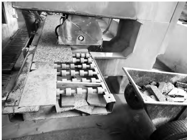
**Figura 76** - Encabeçadeira automática monodisco.
