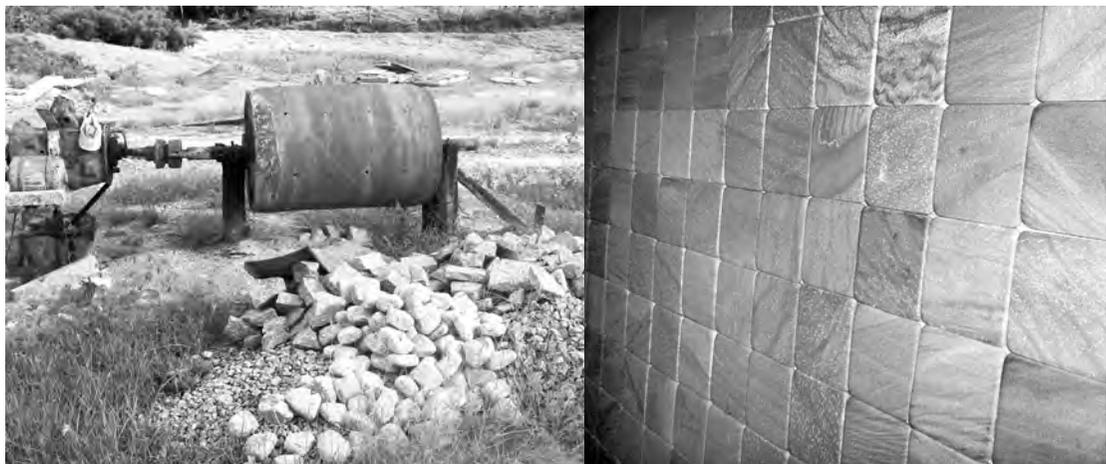
**Figura 40** - Equipamento de seixos e revestimento de anticato. Fotos: CETEM/MCTI, 2006.
