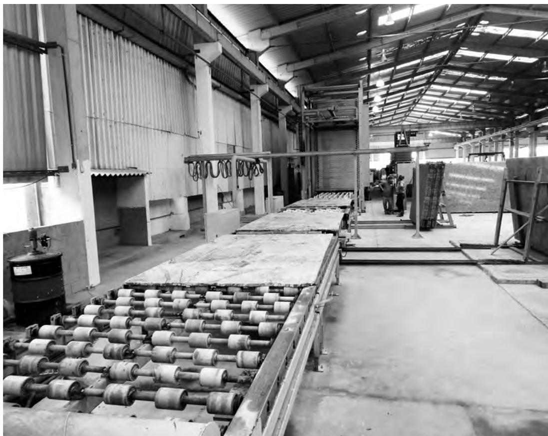
**Figura 38** - Linha de resinagem automática. Foto: CETEM/MCTI, 2011.
