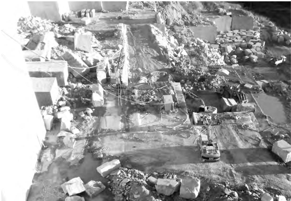
**Figura 30** - Pedreira com avanço ascendente pelo método de pranchas verticais (esquerda da imagem) e descendente por bancadas altas (direita da imagem). Foto: CETEM/MCTI, 2013.
