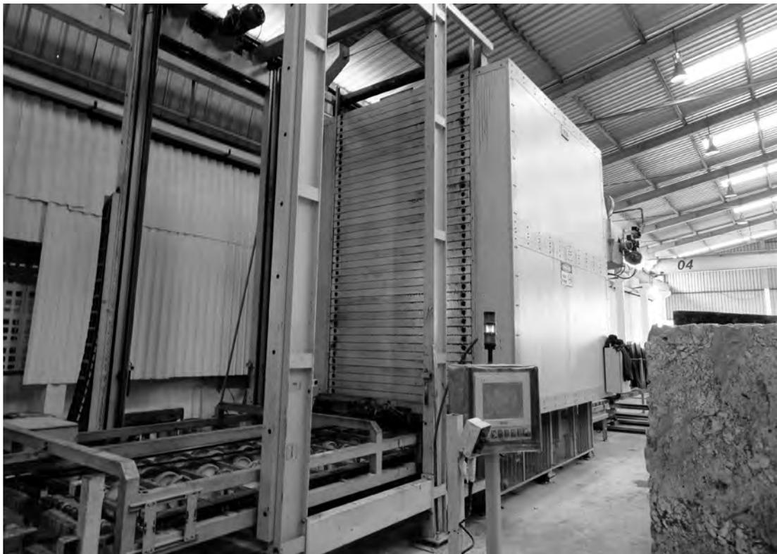
**Figura 40** - Detalhe do forno catalisador de cura. Foto: CETEM/MCTI, 2011.
