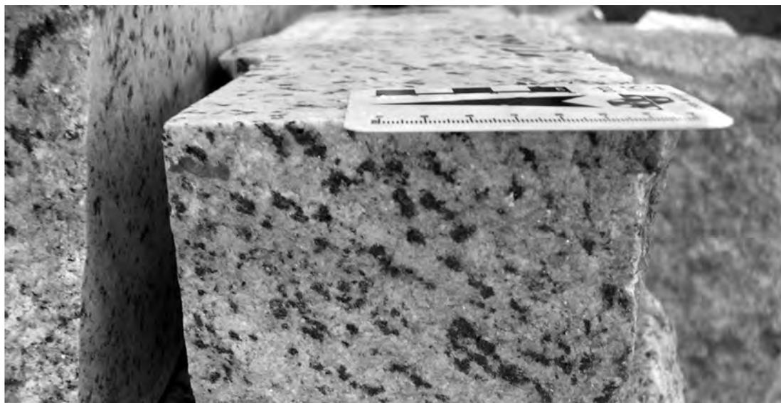
**Figura 24** - Exemplo de estrutura gnáissica. Foto: M.H.B.O.Frascá.
