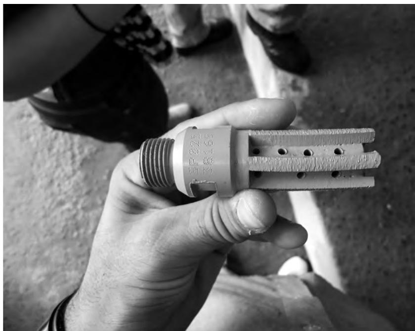
**Figura 84** - Ponta gráfica diamantada para execução de furos em peças de marmoraria. Foto: CETEM/MCTI, 2010.
