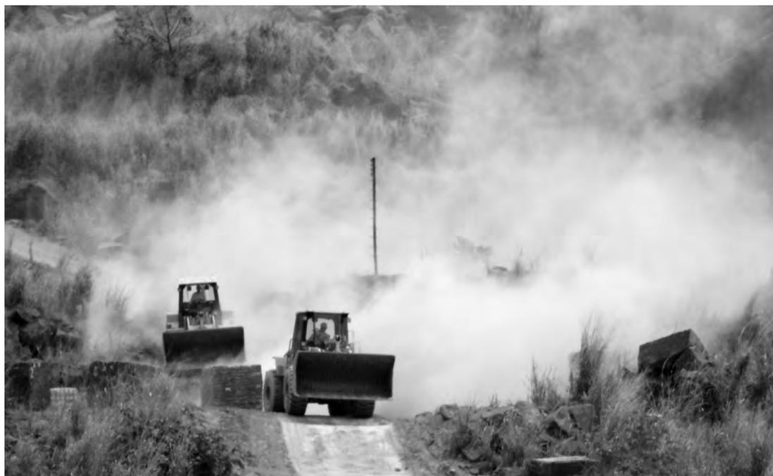
**Figura 3** - Poeira gerada pela circulação de máquinas pesadas em pedreira. Foto: CETEM/MCTI, 2011.
