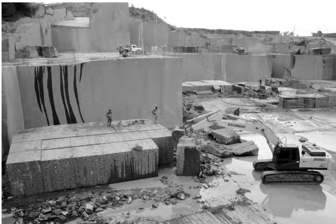
**Figura 24** - Movimentação dos blocos cortados da prancha. Foto: CETEM/MCTI, 2012.
