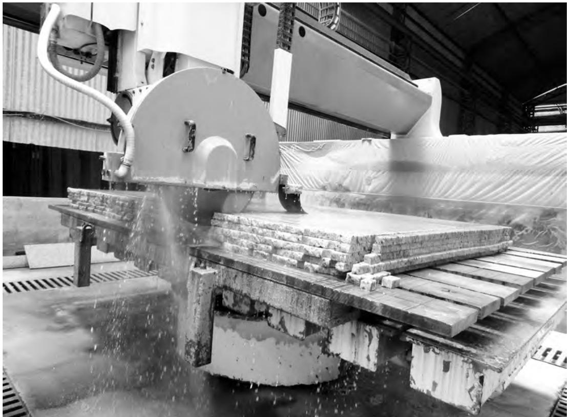
**Figura 85** - Serra ponte de cabeçote móvel. Foto: CETEM/MCTI, 2011.
