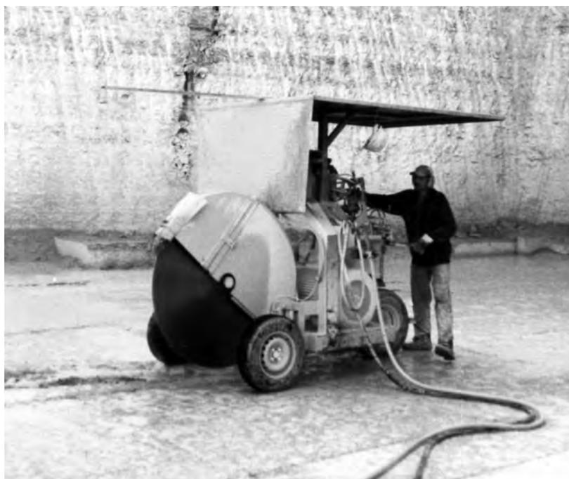
**Figura 55** - Cortadora de disco diamantado (Itália). Foto: CETEM/MCTI, 2006.
