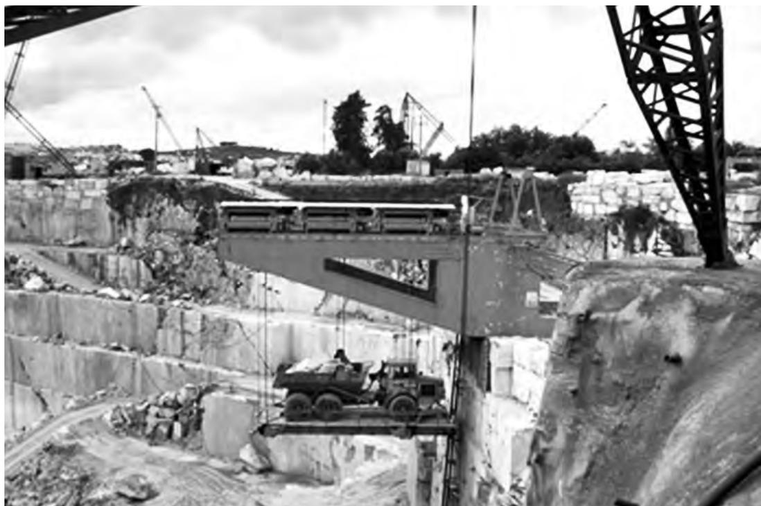
**Figura 104** - Detalhe da subida do elevador utilizado para retirar estêreis. Foto: CETEM/MCTI, 2007.
