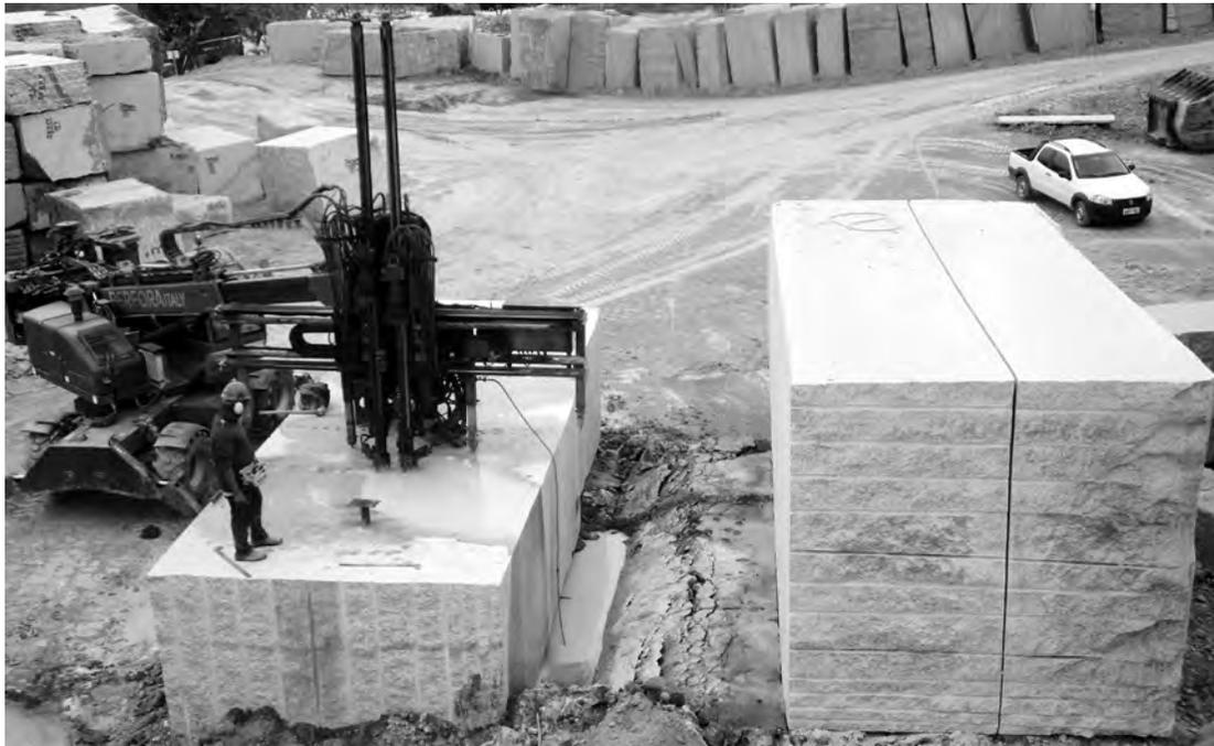
**Figura 59** - Perfuratriz hidráulica (banqueadora) usada para o esquadreamento de blocos. Foto: CETEM/MCTI, 2012.
