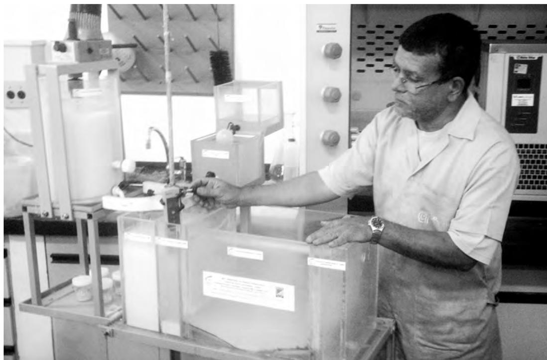
**Figura 43** - Protótipo de tanque de decantação desenvolvido para as serrarias de Santo Antônio de Pádua.
