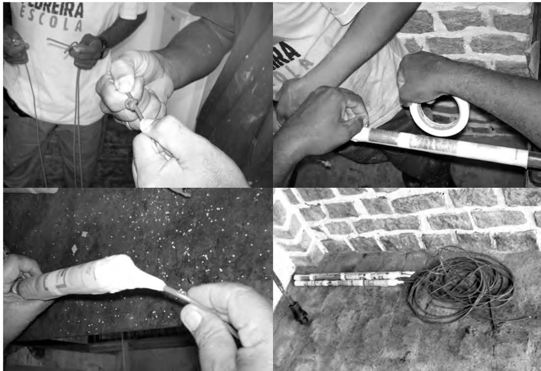
**Figura 5** - Preparação de explosivo para corte do maciço. Fotos: CETEM/MCTI, 2007.
