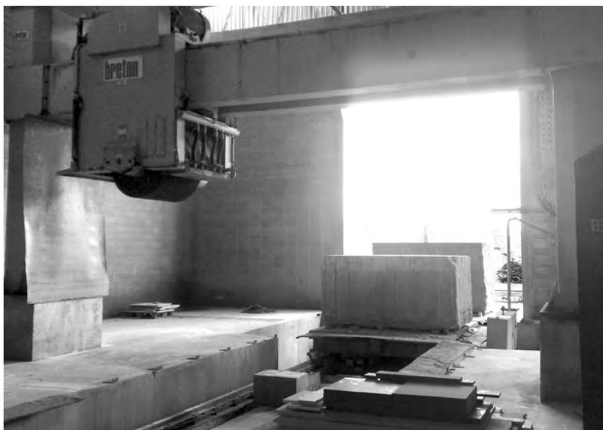
**Figura 25** - Talha-blocos multidisco diamantados de 2 colunas. Foto: CETEM/MCTI, 2011.
