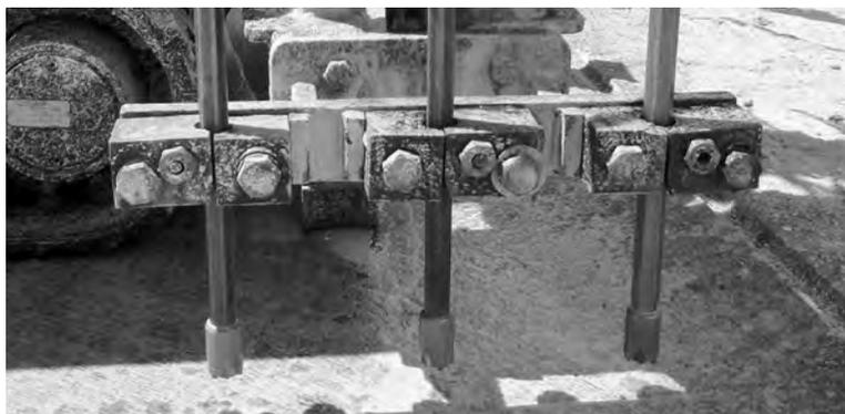
**Figura 67** - Bits de perfuração montados nas hastes.
