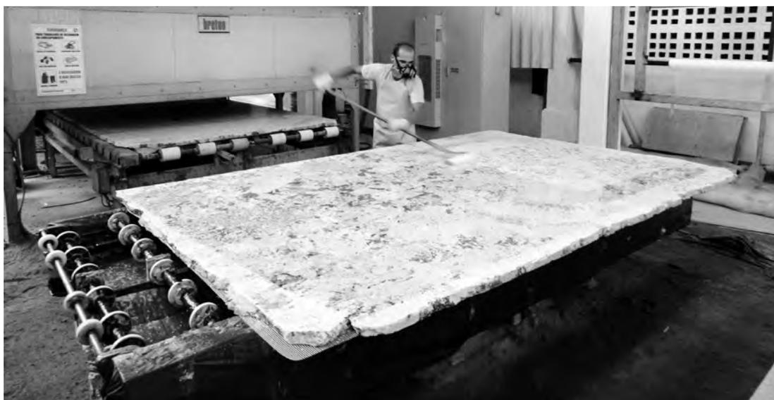
**Figura 46** - Forno de desumidificação para aplicação de resina no processo de telagem. Foto: CETEM/MCTI, 2011.
