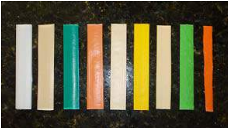
Figura 4.1 - Corpos de prova (fitas) ordenados segundo sua composição de resíduo de mármore.
