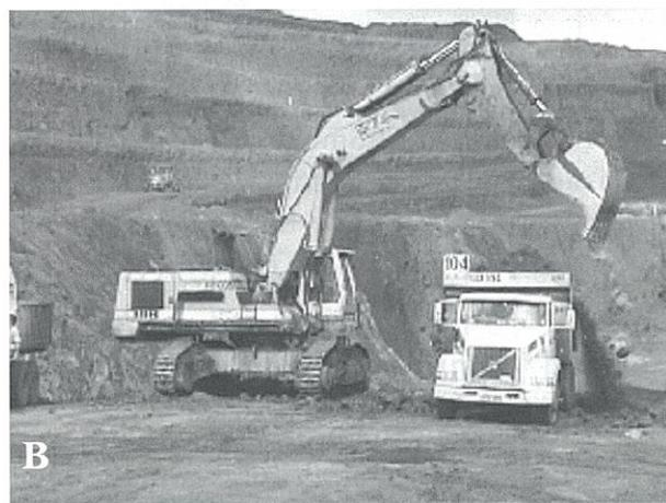
**Figura 1: (A) Vista panorâmica da mina de Araxá. (B) Carregamento e transporte de minério.**
