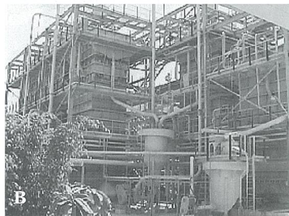
**Figura 4:** (A) Vista parcial do circuito de células de flotação das etapas *rougher* e *scavenger*. (B) Colunas de flotação.
