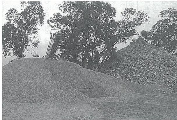
Figura 6: Pilhas dos produtos de brita 2 (à esquerda) e brita 3.
