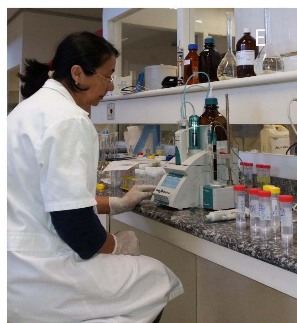
5 mL de solução amostra + 15 mL de TISAB + potenciometria
