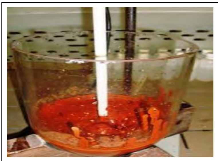
Figura 8. Homogeneização e dispersão da amostra de lama vermelha.
