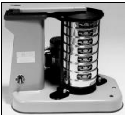
Figura 7. Peneirador vibratório, do tipo ro-tap , utilizado nos ensaios de resistência à abrasão.
