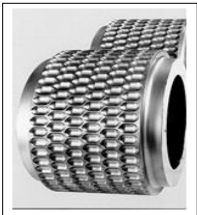
Figura 9. Rolos sólidos, que permitem a substituição das tiras que dão forma aos briquetes.
