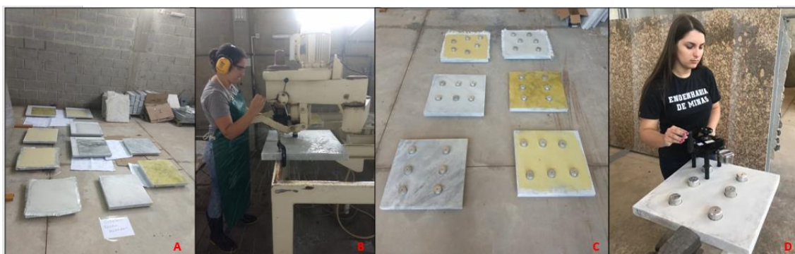
Figura 2: Amostras resinadas (A), preparação dos furos (B), amostras prontas para o ensaio de resistência à tração (C) e ensaio sendo realizado com equipamento de arrancamento (D).
