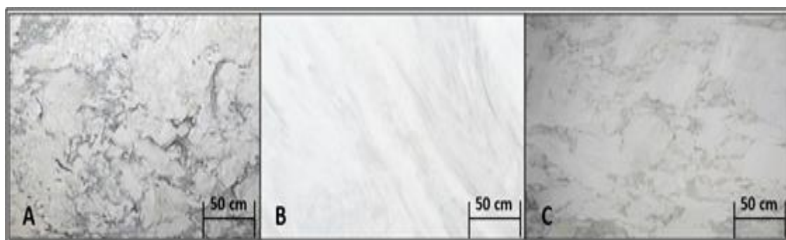
Figura 1: Chapas das rochas carbonáticas: Superlative (A), White Shadow (B) e Matarazzo (C).
