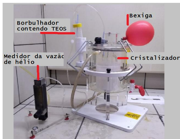
Figura 1: Cristalizador utilizado nos experimentos. A bexiga cheia sinaliza a pressão positiva no cristalizador.
