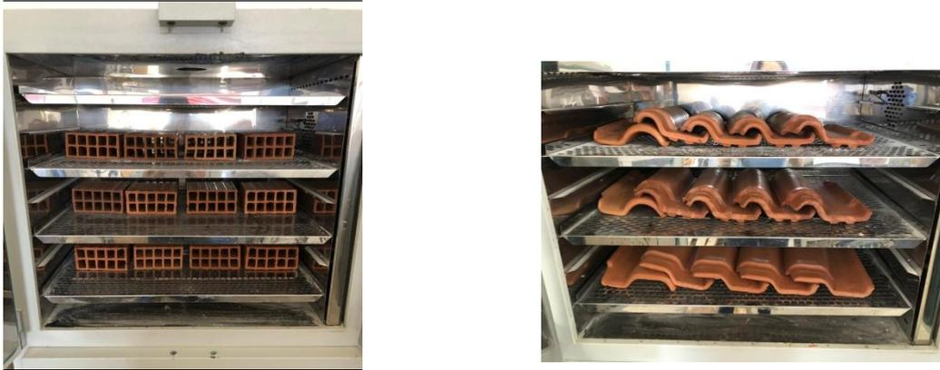
Figura 3. Secagem dos materiais cerâmicos.
