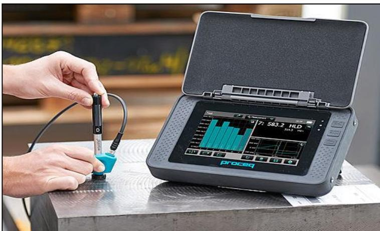
**Figura 14.** Equipamento usado para medir a dureza (Modificado de PROCEQ, 2016).
