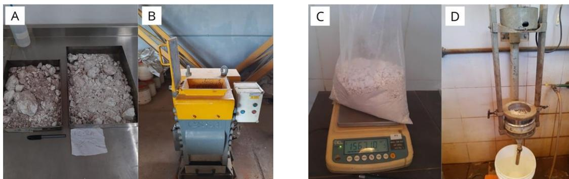
**Figura 1:** Preparação e beneficiamento das amostras de caulim na Usina Piloto. A) Amostra bruta. B) Britador de mandíbula. C) Pesagem da amostra. D) Peneirador.
