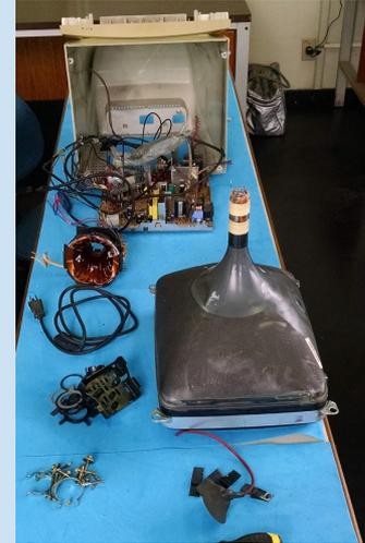
As partes principais são as placas, fios, carcaça plástica, metais, yoke (cobre) e a tela junto ao tubo CRT.
