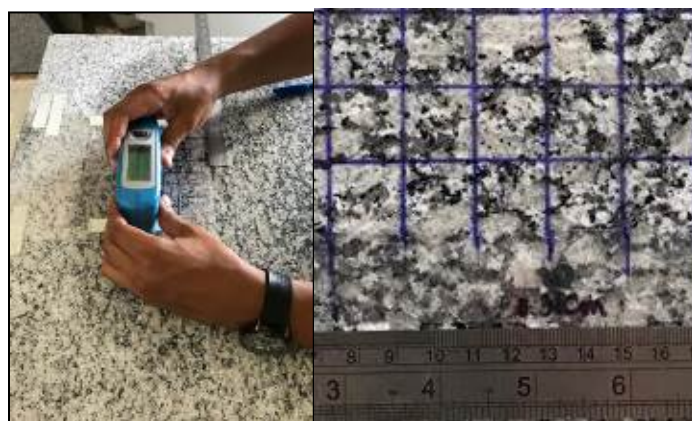
Figura 2. Coleta do brilho com o medidor e área amostrada.
