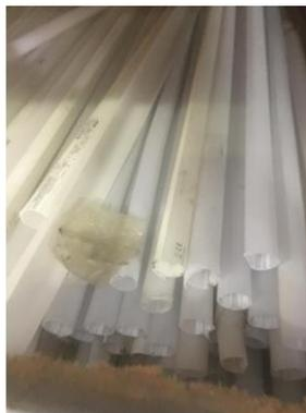
**Figura 3: Plástico retirado das lâmpadas de LED.**
