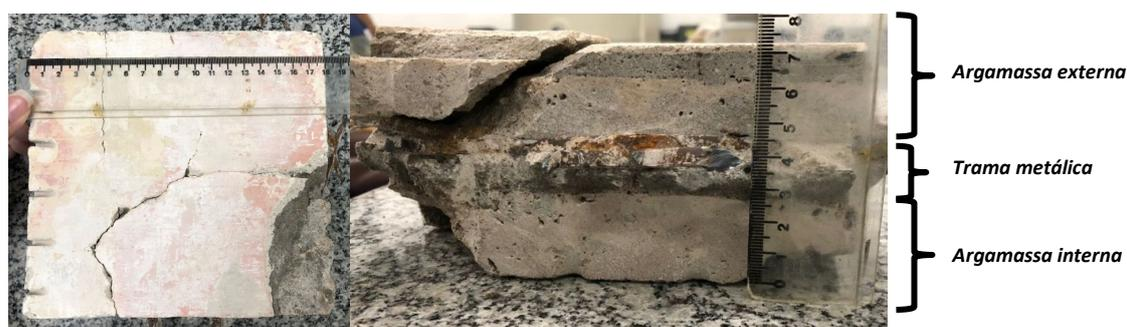
Figura 3: (A) Amostra retirada do MNBA (B) Seção transversal da amostra.
