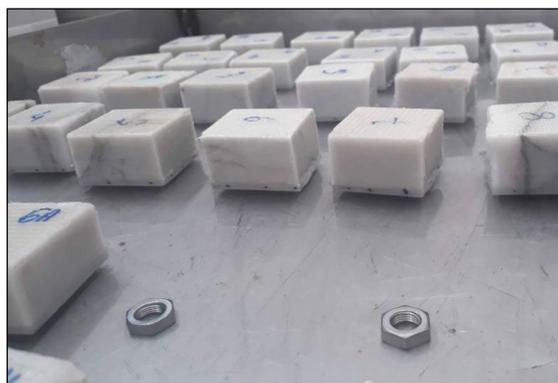
**Figura 2:** Ensaio de absorção por capilaridade em andamento.
