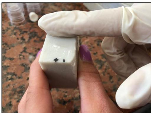
**Figura 1:** Aplicação do silicone nas laterais nos corpos de provas.
