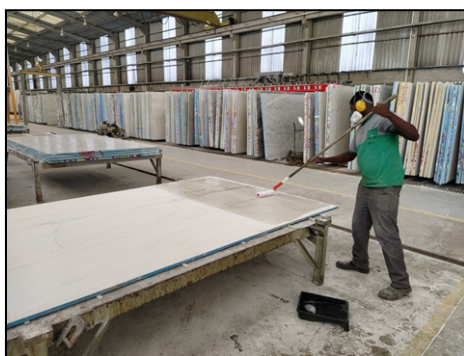
Figura 1: Aplicação de impermeabilizantes em chapas de quartzito.
