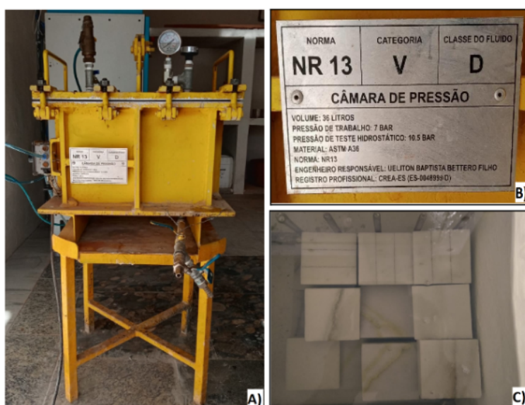
Figura 3: A) Câmara de pressão; B) Especificações técnicas da câmara; e C) Corpos de prova imersos no impermeabilizante.
