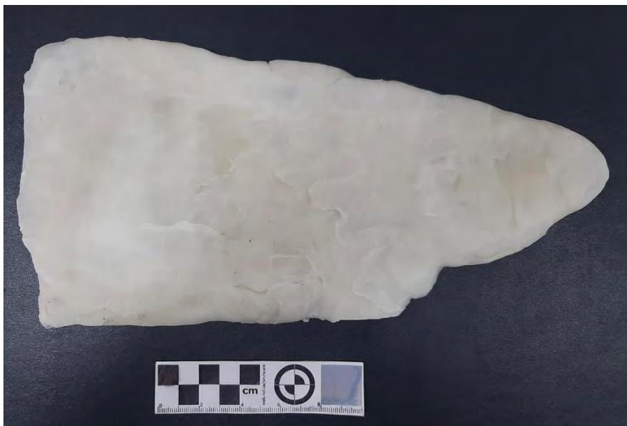
**Figura 2:** Protótipo da asa do anjo confeccionada em impressora 3D de pó.
