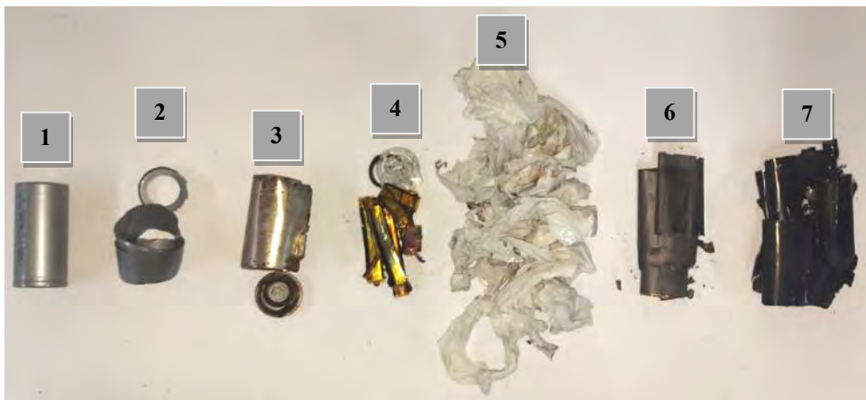
Figura 3 - Componentes de uma célula de LFP. Em (1) a célula antes da abertura, (2) o invólucro polimérico, (3) carcaça de aço, (4) interconectores do cátodo e ânodo, (5) separador polimérico, (6) ânodo e em (7) cátodo.
