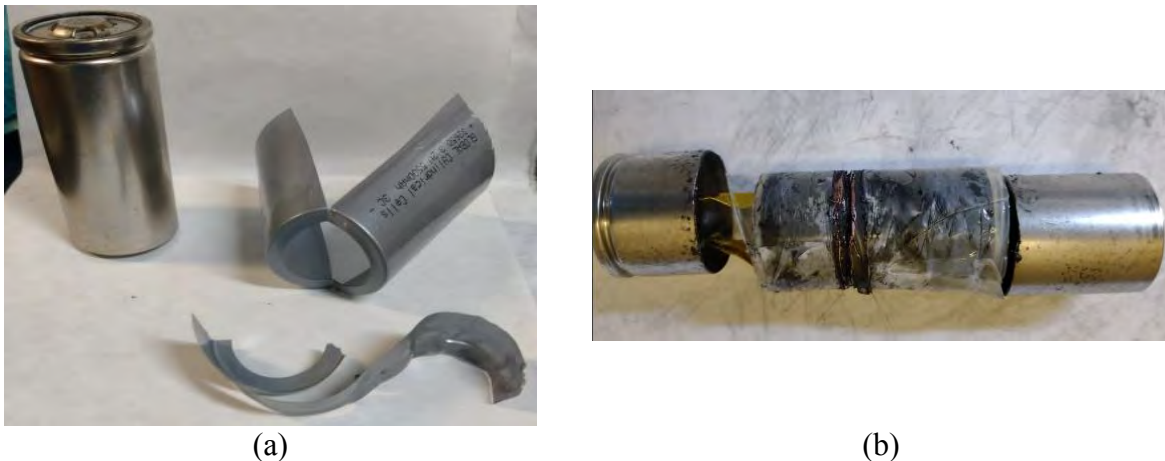
Figura 1 - Processo de abertura manual das células de LFP. Em (a) a retirada do invólucro polimérico e em (b) o corte transversal da carcaça de aço para expor os componentes internos das células de LFP.
