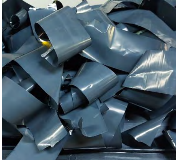
Figura 2 - Fitas de cátodo separadas para beneficiamento por moagem de facas. Fonte: AUTOR, 2023.
