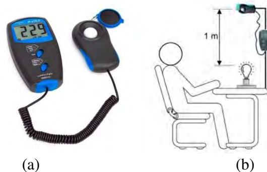
Figura 2 – Medição da intensidade luminosa: (a) luxímetro minipa MLM-1011; (b) esquema do procedimento de medição. Fonte: AUTORES, 2023.
