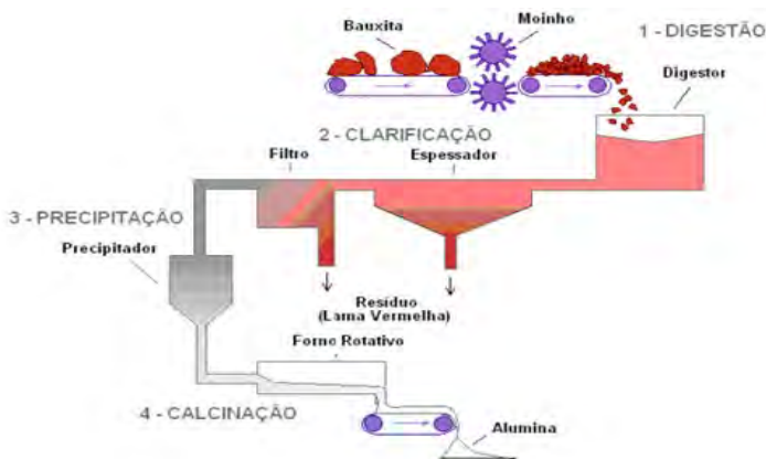
Figura 1. Fluxograma do processo Bayer.
