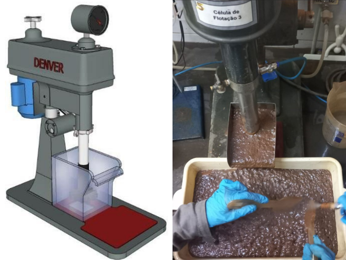
Figura 2. Máquina de flotação mecânica Denver, modelo D12 do CETEM utilizada nos ensaios de flotação em escala de bancada.
