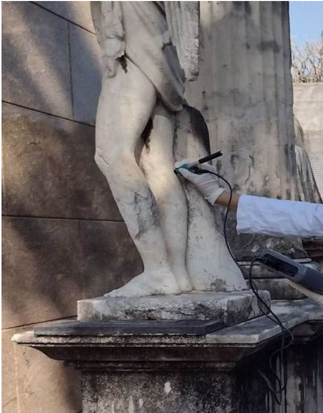
Figura 13. Realização de ensaio de dureza in situ .
