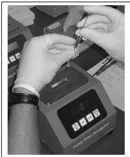
**Figura 3.2** Equipamento Infracal, modelo HART-T da Wilks Enterprise.
