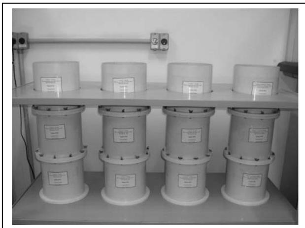
**Figura 3.1** Sistemas estáticos usados nos ensaios de biorremediação dos solos contaminados com diesel (B0) e diesel/biodiesel (B4).
