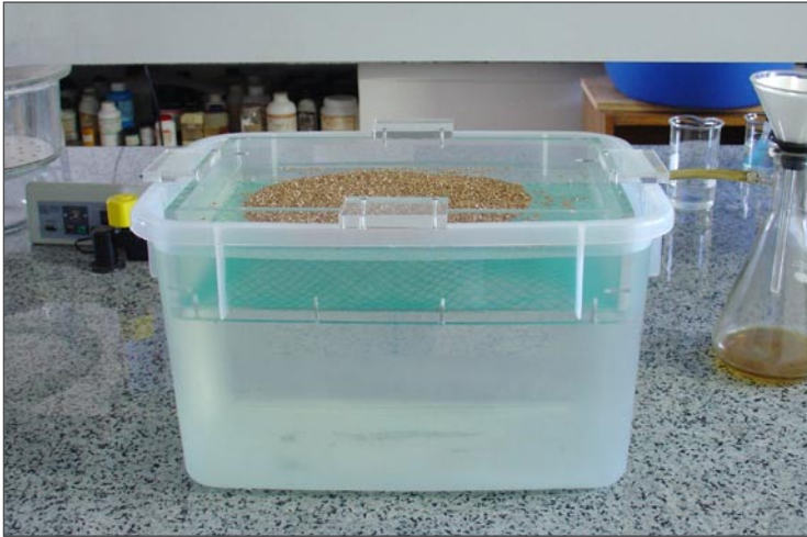
Figura 3.1: Vista de topo dos ensaios de adsorção de óleo pela vermiculita.
