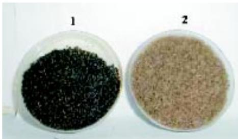
**Foto 2:** Solo arenoso antes e após o tratamento com Fenton. Amostra 1: Sem tratamento com Fenton. Amostra 2: Após o tratamento, nas melhores condições obtidas do planejamento experimental.  $H_2O_2 = 4M$ ;  $Fe^{2+} = 2,7 g/L$ ; Areia =  $25g/L$ ; Tempo = 6h;  $pH = 3$ .
