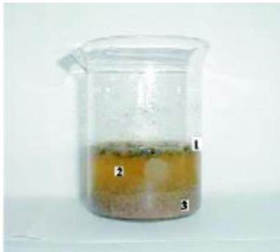
**Foto 1:** Verificação da separação do óleo após a reação de Fenton. Fase1: óleo emulsionado que ficava à superfície da solução; Fase 2: Fase aquosa que era filtrada para obtenção do óleo dissolvido; Fase 3: Areia limpa analisada no planejamento 2<sup>(4-1)</sup>.
