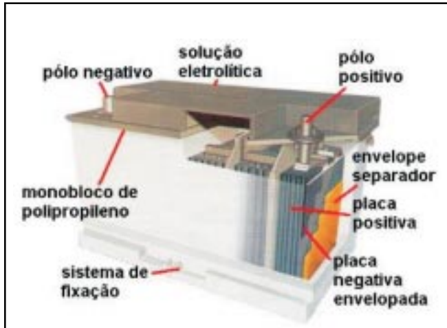
Esquema de bateria automotiva
