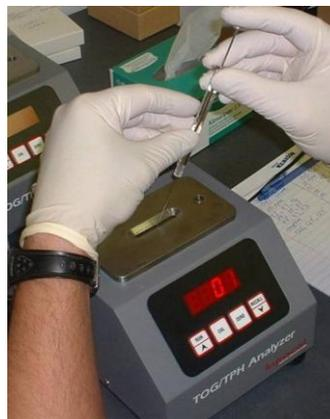
**Figura 2. Equipamento Infracal, modelo HART -T da Wilks Enterprise.**
