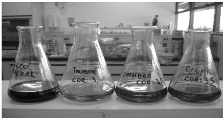
Figura 4 – Amostras de óleo mineral in natura e descorado.
