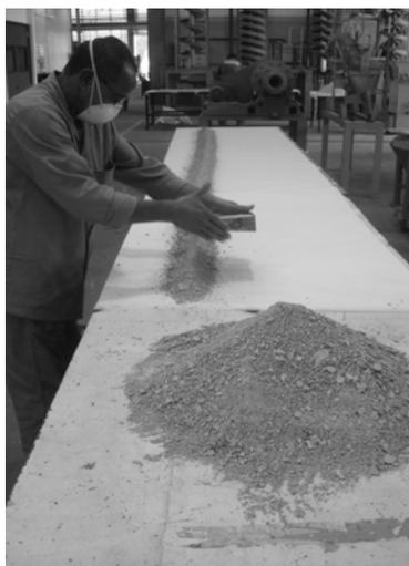
Figura 2. Homogeneização das amostras de bentonita.
