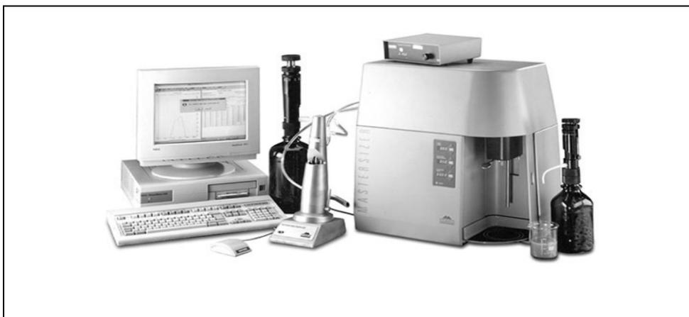
Figura 4 – Foto do equipamento Malvern Mastersizer MicroPlus, MAF 5001 (Laboratório de Sistemas Particulados, PEQ/COPPE/UFRJ).
