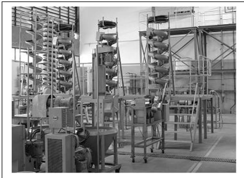
Figura 2 – Vista panorâmica das espirais concentradoras existentes na unidade piloto do CETEM.
