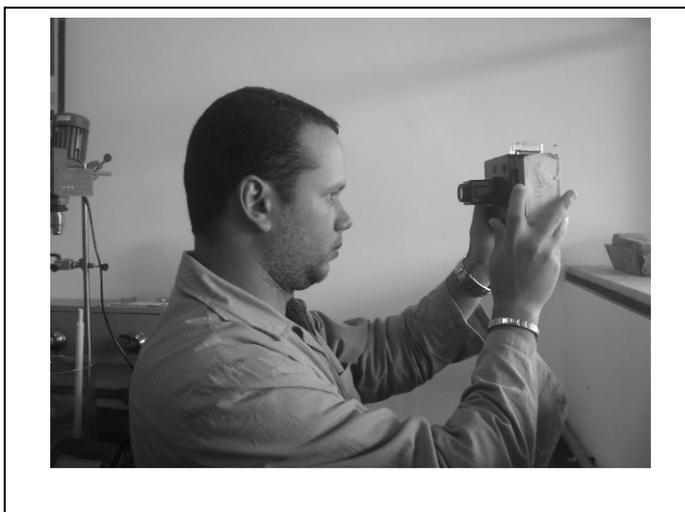
Figura 4 – Posicionamento do colorímetro ASTM, existente no CETEM, para determinação de cor.
