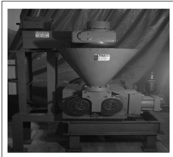
Figura 1 – Máquina contínua de briquetagem existente no CETEM.
