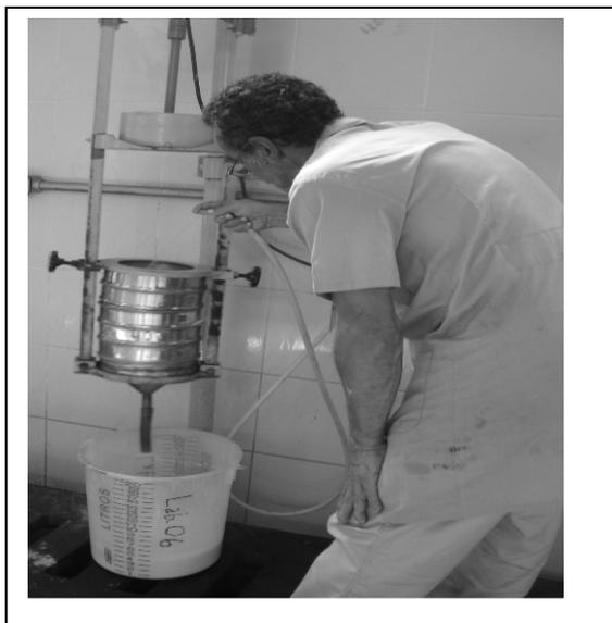
Figura 5 – Peneiramento a úmido, em escala de laboratório.
