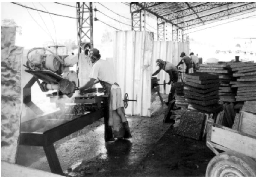
Figura 4 – Corte de lajes em serras de disco diamantado
