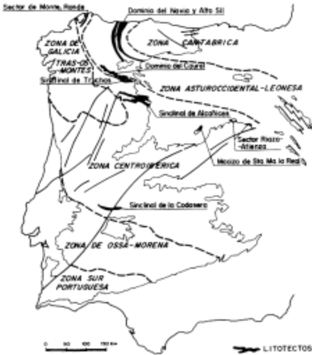
Figura 3 – Litotectos de pizarras para cubiertas. Fuente: Lombardero y Quereda, 1991.
